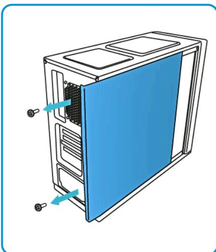
**Odstráňte skrutky** z ľavého bočného panela a panel zložte. Ak skrutky nie sú prítomné, riadte sa návodom k použitej skrinke.
